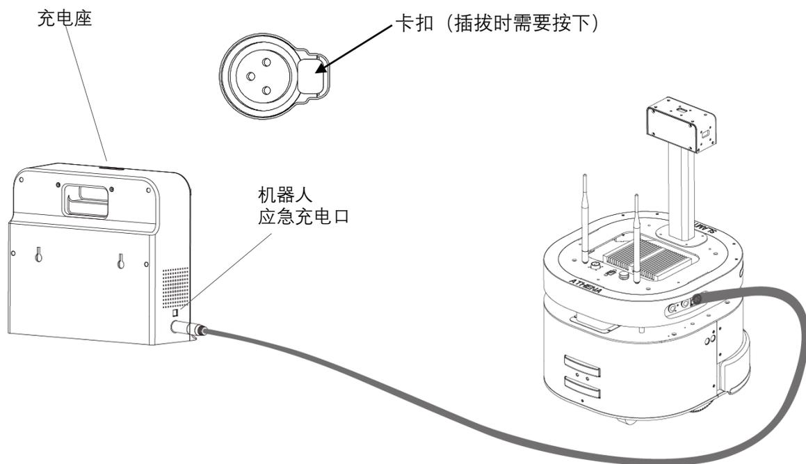
图表 4-6 手动充电连接示意图
