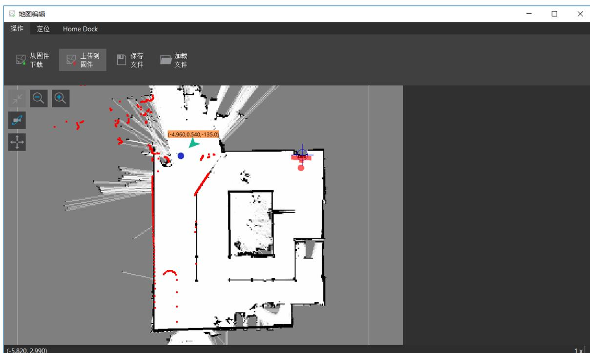
图表 4-5 RoboStudio 机器人地图编辑器窗口
