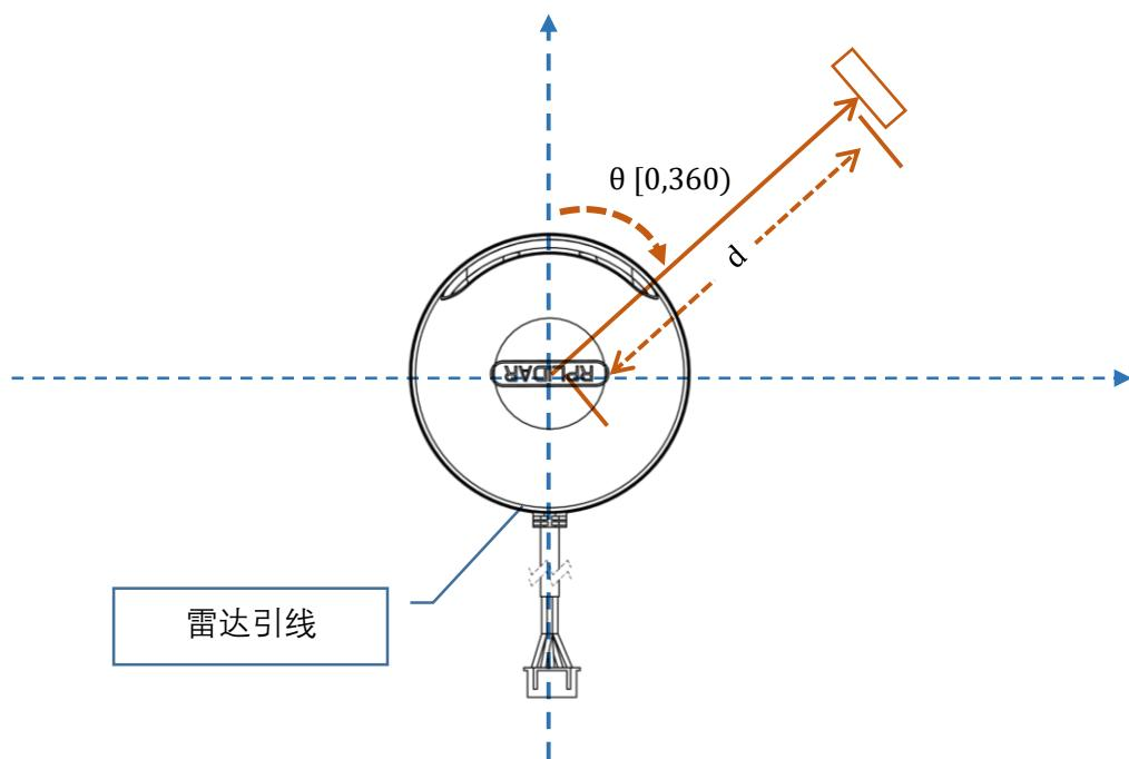
图表 2-5 RPLIDAR 扫描数据坐标系定义
