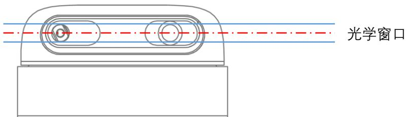
图表 2-4 RPLIDAR 光学窗口示意图
