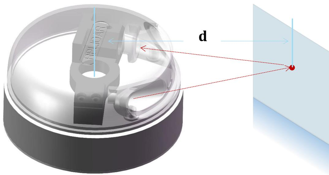
图表 1-2 RPLIDAR A2 工作原理示意图
