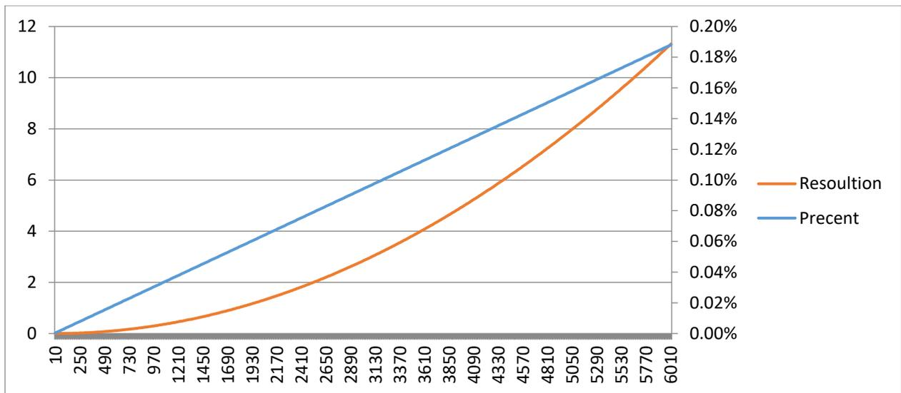
图表 2-2 RPLIDAR 测距系统距离分辨率随实际距离变化趋势图
