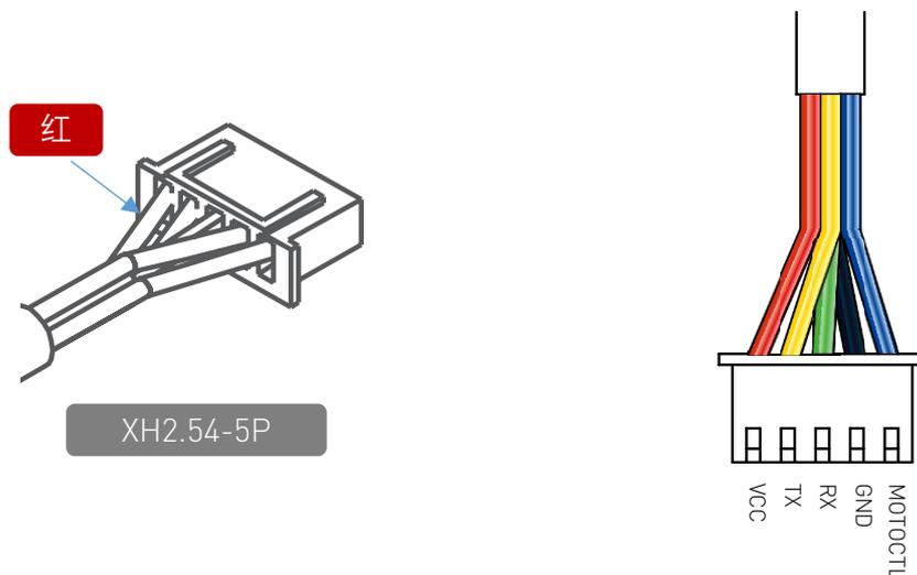
图表 2-6 RPLIDAR 电源接口定义示意图
